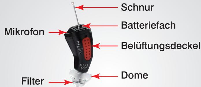
Standard-**alfa3 BOX**-Geräte werden separat für das rechte und das linke Ohr hergestellt.
